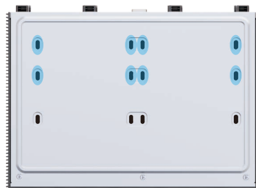
Para instalar disco duro de 3.5 pulgadas
