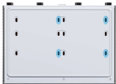
Para instalar disco duro de 2.5 pulgadas
